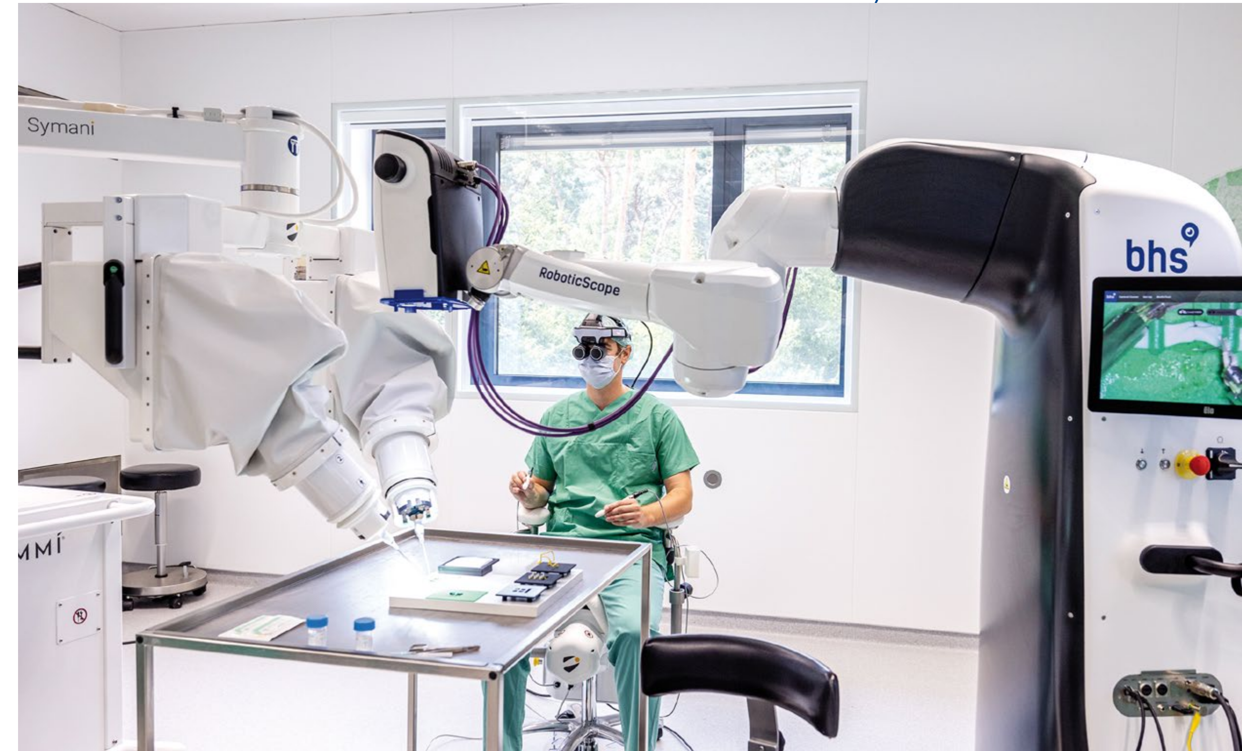
Priv.-Doz. Dr. Maximilian Kückelhaus mit dem Operationsroboter (l.), der mit einem robotischen Mikroskop (r.) vernetzt ist
